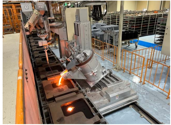
IoT を駆使した自動注湯機
