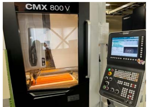
マシニングセンタによる模型製作
