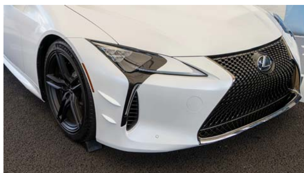
空気抵抗低減に寄与するバンパーカナード (インクリメンタル成形)
