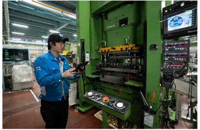
自社開発 PRMS (Press remote monitoring system) による異常の見える化
