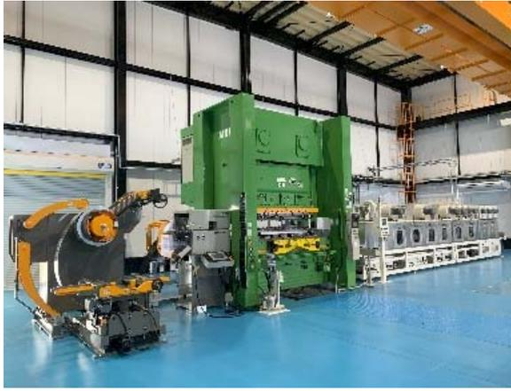
プレス加工、洗浄、検査梱包、パレット積み
