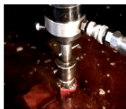
図2 形彫放電加工機の加工中の様子
