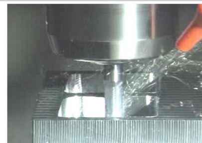
ポケット加工の時間短縮 (エポックミルの切削領域)
