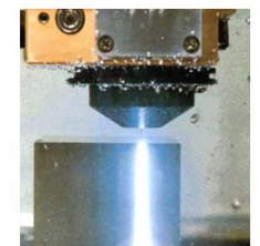
ワイヤ放電加工機の加工中の様子
