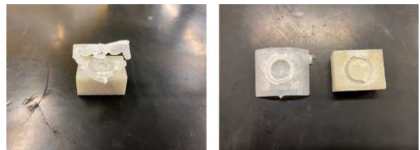
図2 PA6GB 製入れ子でPEを成形した際の問題点 (1回目の成形で入れ子と成形品が離型できない)
